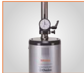
Kalibratie met analoge meetklok
