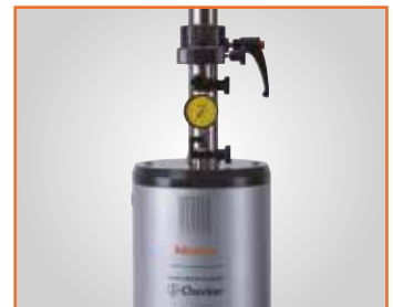
Kalibratie met zwenktaster accessoireset (horizontaal model)
