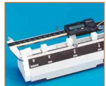
Nauwkeurigheid van schuifmaat controleren (buitenmeting)
