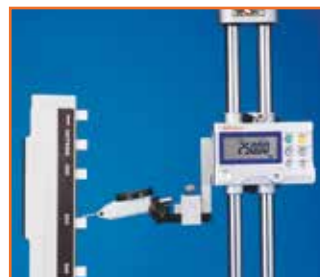
Nauwkeurigheidscntrole van hoogtemeter
