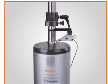
Inspectie met hendeltaster (inductieve sonde)
