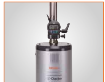
Kalibratie met gebruik van digitale meetklok
